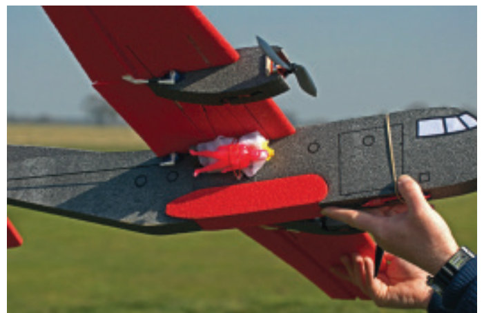
So werden die Springer in die Gummischlaufe eingesteckt. Fährt das Servo in die andere Endposition, schlüpft der Gummi aus dem Ruderhorn.
