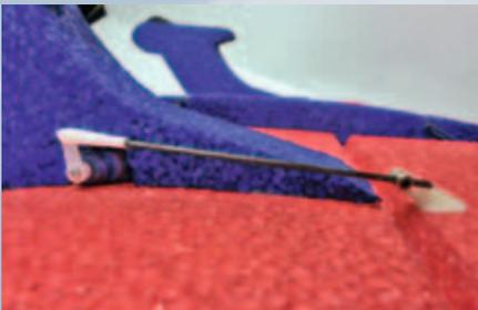
▲ **Gut vorbereitet:** Für die Querruderservos gibt es Aussparungen in den Fahrwerksbeinen, die Anlenkungsteile liegen bei.
